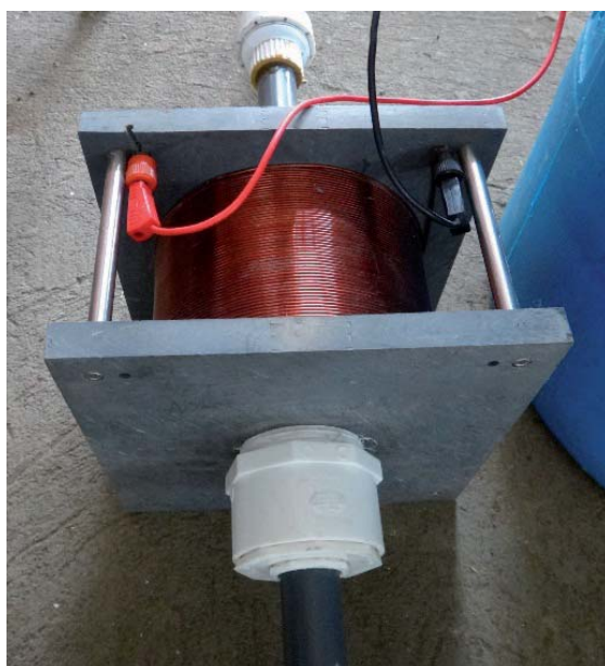
Figura 1. Solenoide adaptado al circuito de recirculación.
